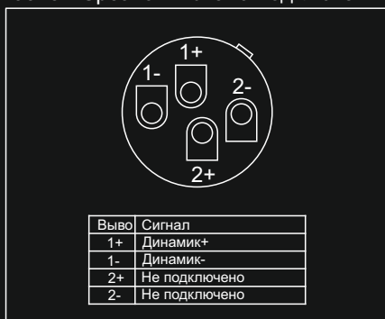
Разъем Speakon и схема подключения
